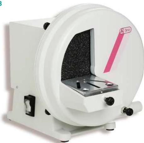
Recortadora con disco diamante de la marca Sirio
