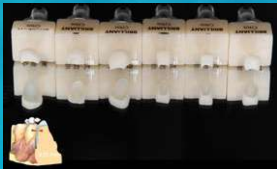
Fresado de restauraciones mínimamente invasivas en BRILLIANT Crios A2 HT.
