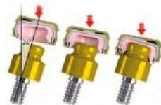
**OT EQUATOR Smart Box** - La nueva Smart Box consta de un contenedor exterior con un teflón interior móvil hasta 25° que permite de este modo la inserción hasta divergencias extremas de 50° entre dos implantes.
