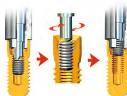
Primero se marca el tornillo con el punzón (A) y a continuación montado en el micromotor de implante con una velocidad muy baja de aprox. **500 rpm**, ejerciendo presión, se extrae el tornillo en **sentido antihorario**. Si lo anterior con funciona se sigue con la fresa. Se monta en el micromotor y a velocidad de 500 rpm se gira a mano en sentido horario, y una vez bloqueada se extrae en **sentido antihorario**.
