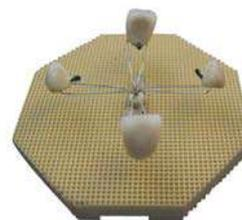
Bandeja refractaria "Araña" para fijar trabajos de circonio y cerámica inyectada de forma segura
