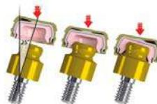
**OT EQUATOR Smart Box** - La nueva Smart Box consta de un contenedor exterior con un teflón interior movable hasta 25° que permite de este modo la inserción hasta divergencias extremas de 50° entre dos implantes.
