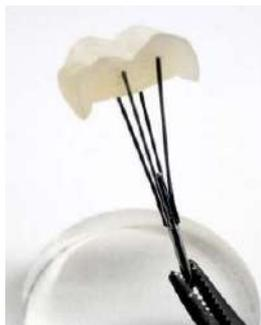
Pines de 4 alambres de 0,4 mm de grosor cada uno. Pueden separarse para conseguir la forma necesaria para la sujeción segura durante la cocción.
